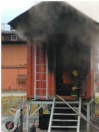
Kuva 2. Sisäpalosimulaattori ja sen polttomateriaali (lastulevy)
